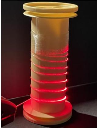
Gesponnenes Licht: Diese Polymerfasern leiten Licht und sind mit einem neuen Mikrofluidik-Nassspinnverfahren hergestellt. Bild: Empa
